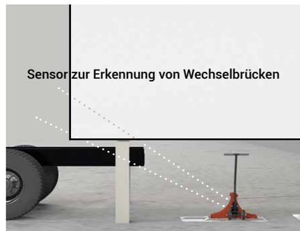
Sensor zur Erkennung von Wechselbrücken
